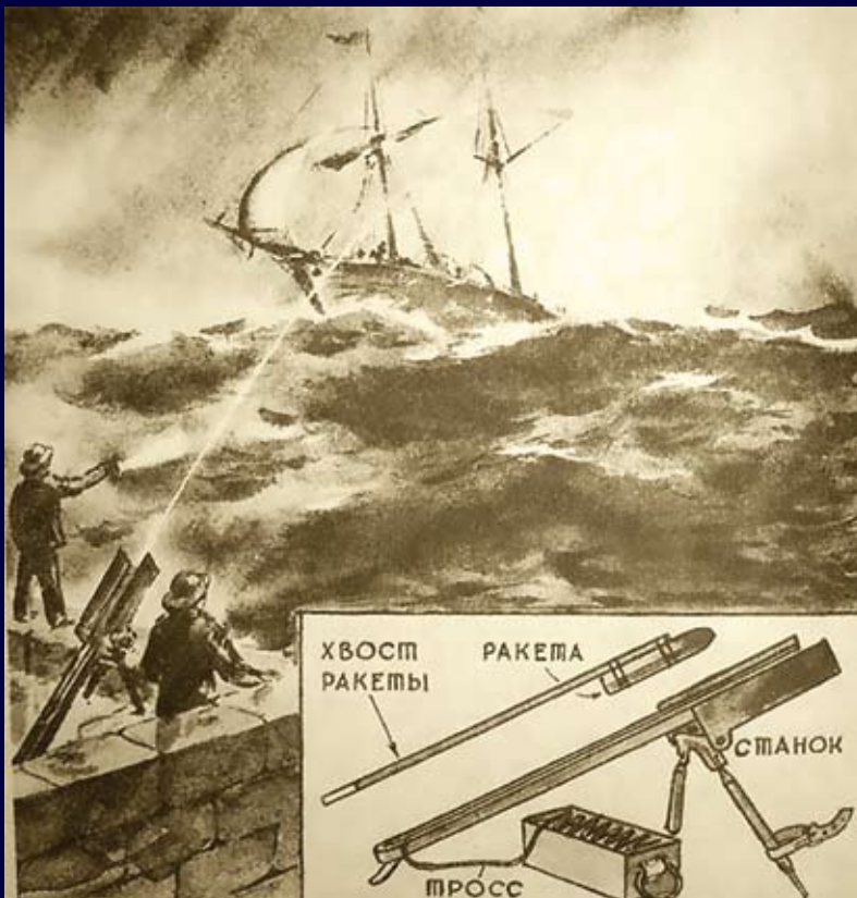
Рятувальні ракети К.І. Константинова для перекидання тросу на потоплюючий корабель
