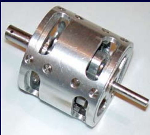
Модуль бортового трибометра. Експеримент «Матеріал-тертя» Onboard tribometer module. The Material and Friction test program
