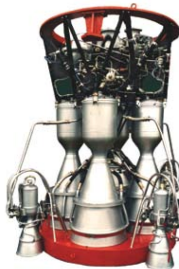
Рідинний реактивний двигун РД-108 В.П. Глушка для ракети-носія Р-7 С.П. Корольова
