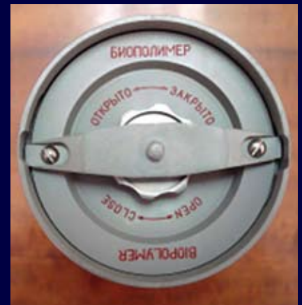
Контейнер для доставки полімерних зразків на орбіту. Експеримент «Біополімер» Container for delivery of polymers samples to orbit. The Biopolymer test program
