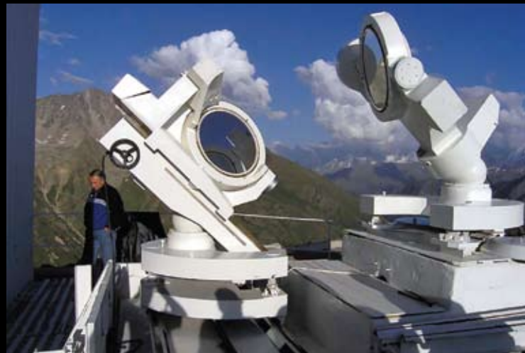
Горизонтальний сонячний телескоп АЦУ-26 The ACU-26 horizontal solar telescope
