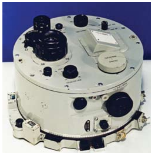
Бортовий секстант «Цель», створений на «Арсеналі» для місячного пілотованого комплексу The Cel onboard sextant, manufactured by the Arsenal Plant for the manned moon complex
