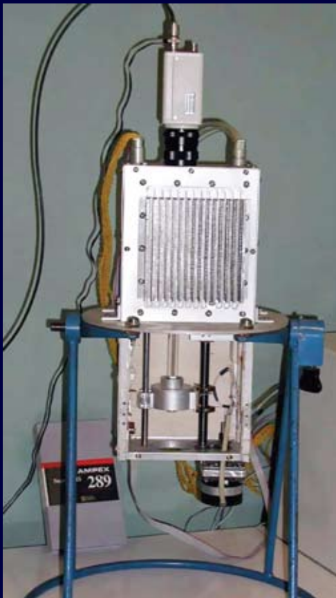
Макет установки для кристалізації об'ємних зразків. Експеримент «Морфос-В» Mockup of the equipment of bulk samples crystallizing. The Morphos-V test program
