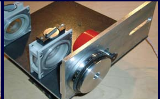
Блок поляроїдного модулятора. Експеримент «Планетний моніторинг» Polaroid modulator block. The Planetary Monitoring test program
