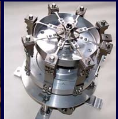
Технологічний зразок блока циклічного навантаження. Експеримент «Пента-втома» Operational sample of the fluctuating load block. The Penta-Fatigue test program
