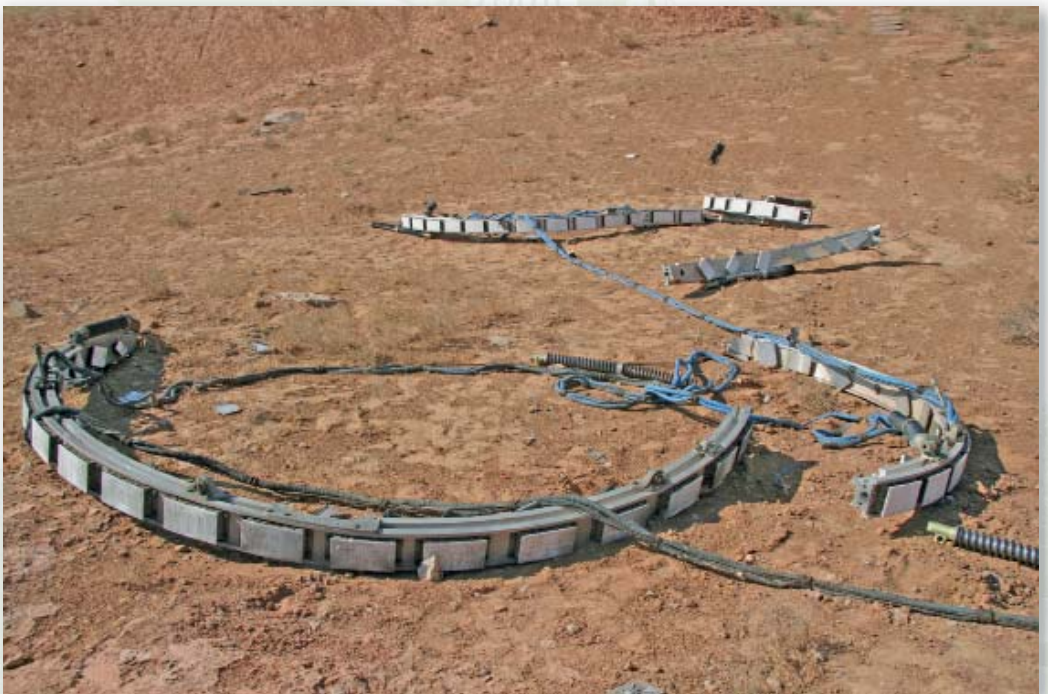
Піддон ракети Р-36М (15А14) після відокремлення та виведення на випробуваннях КВ-2
