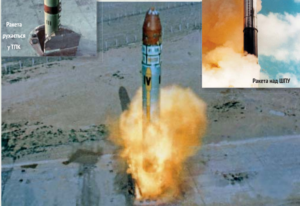
Випробування КВ-4 ракети МР-УР100 (15А15). Вихід ракети із ШПУ
