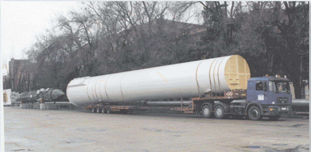
Готова до відправлення замовнику башта вітроенергетичного агрегату
