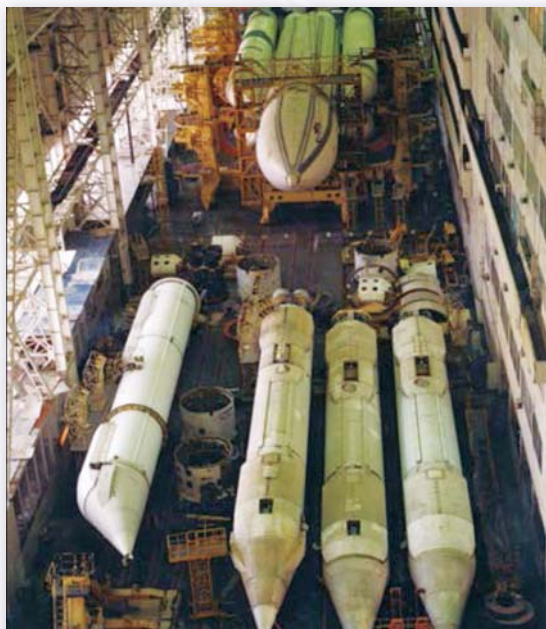
Складання ракети-носія «Енергія» в МВК космодрому Байконур. На передньому плані – чотири бічні блоки першого ступеня, розроблені в КБ «Південне» та виготовлені на Південмаші
