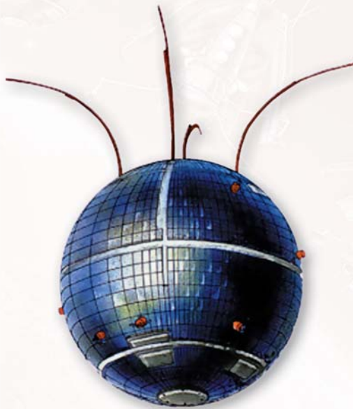
Калібрувальний КА «Тайфун-1», призначений для відпрацювання наземних РЛС системи ППО
