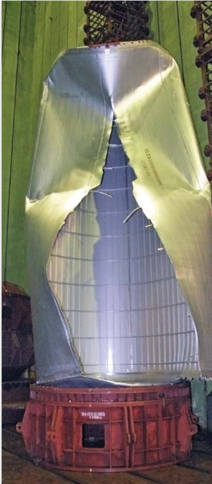
Бак окиснювача після випробувань внутрішнім тиском
