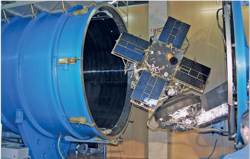
Випробовування КА «ЄгиптСат-1» у термовакuumній камері
