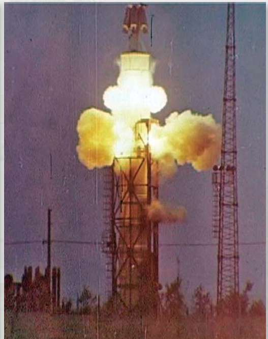
Запуск порохових ракетних двигунів відведення імітатора
