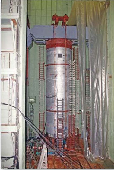
Випробування на міцність основної конструкції першого ступеня
