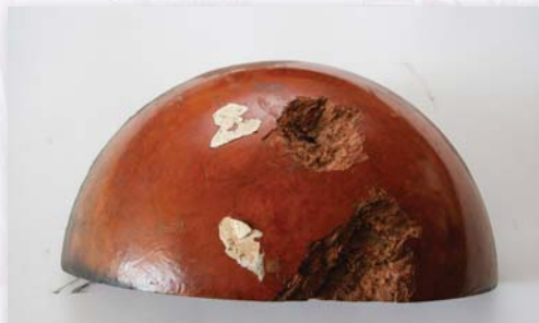
Аеродинамічний наконечник після випробування
