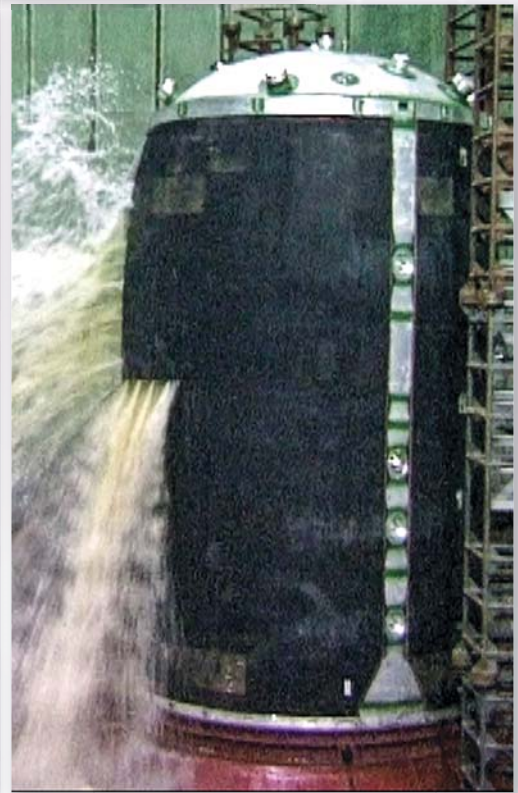
Відпрацювання паливного бака на внутрішній тиск
