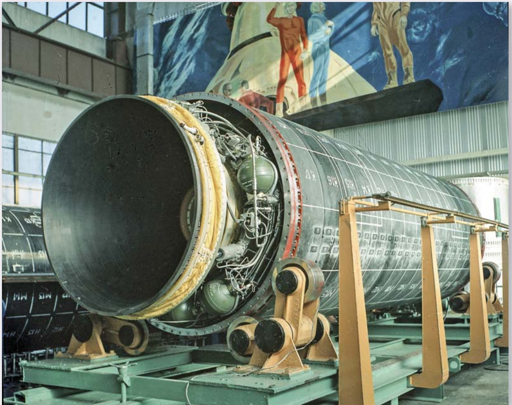
Двигун з поворотним керувальним соплом
