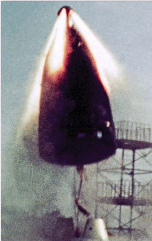
Відпрацювання нового способу відокремлення та відведення головного обтічника ракети 15A18M
