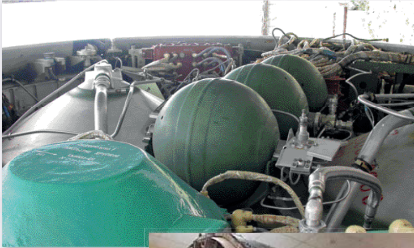
Кулебалони високого тиску на борту ракети 15A18M
