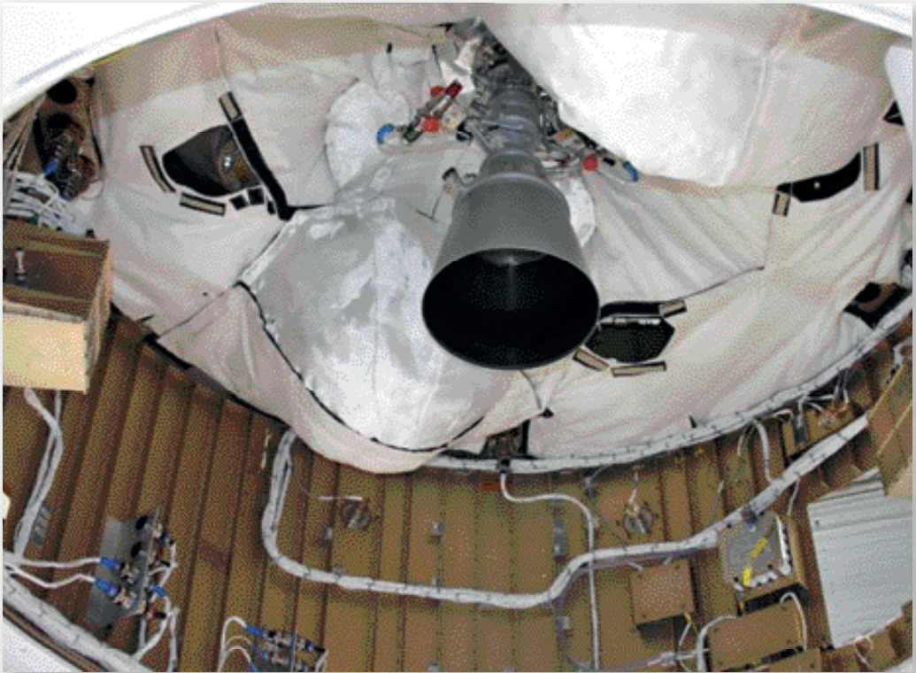
Маршовий двигун, який розробило КБ «Південне» та виготовив Південмаш, установлений на верхній ступінь європейської РН «Вега», січень 2012 р.
