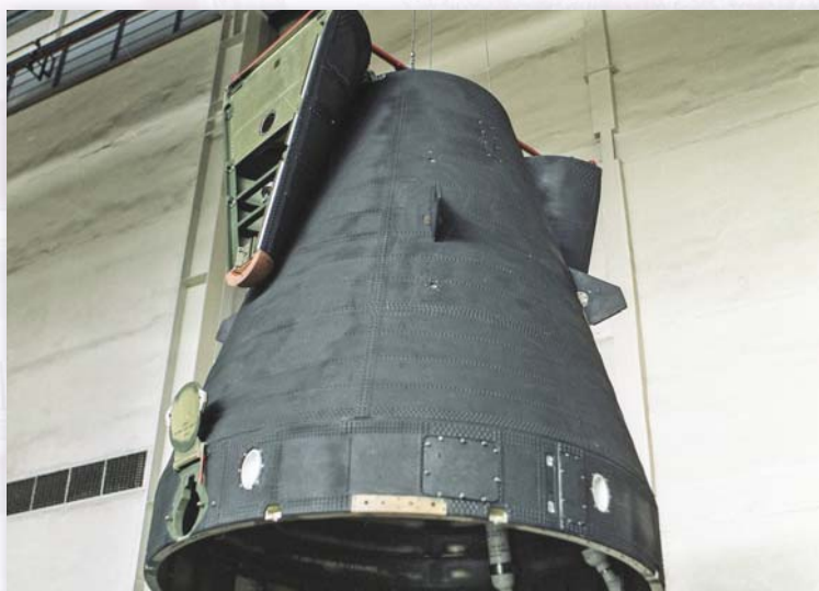
Для скорочення довжини ракет було створено сопла РДТП із телескопічним розтрубом
