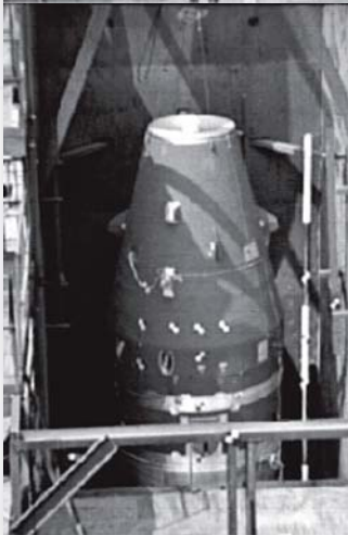
Відпрацювання процесу надування наконечника
