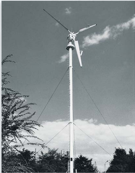
Вітроенергетичний агрегат ВЕГ-10/60
