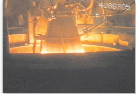
Вогневі випробування двигуна верхнього ступеня РН «Вега»
