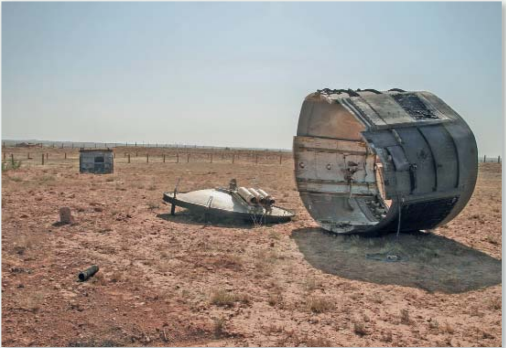
Піддон ракети Р-36М (15А14) після відокремлення та виведення на випробуваннях КВ-2
