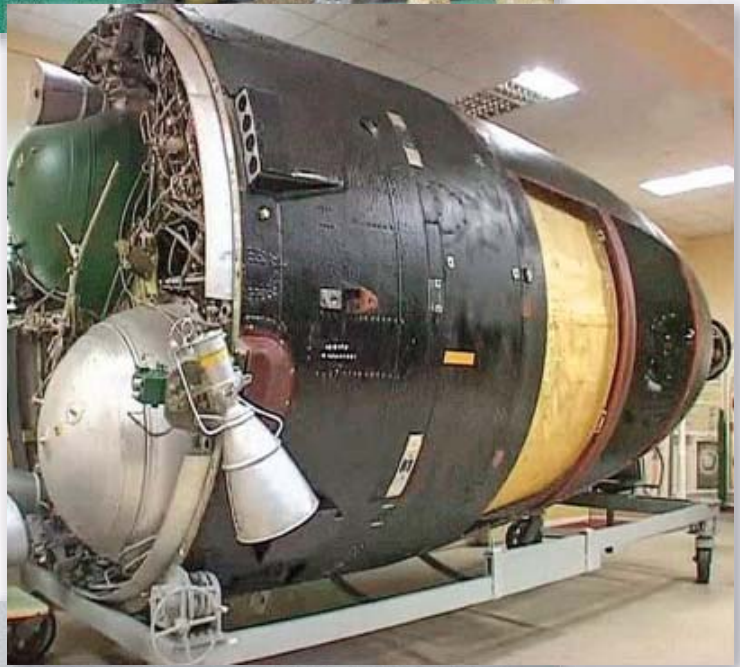
Кулебалони високого тиску на борту ракети 15A18M
