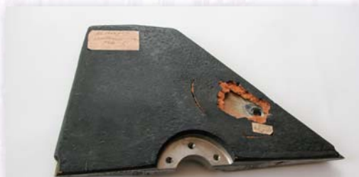
Аеродинамічний руль після випробування
