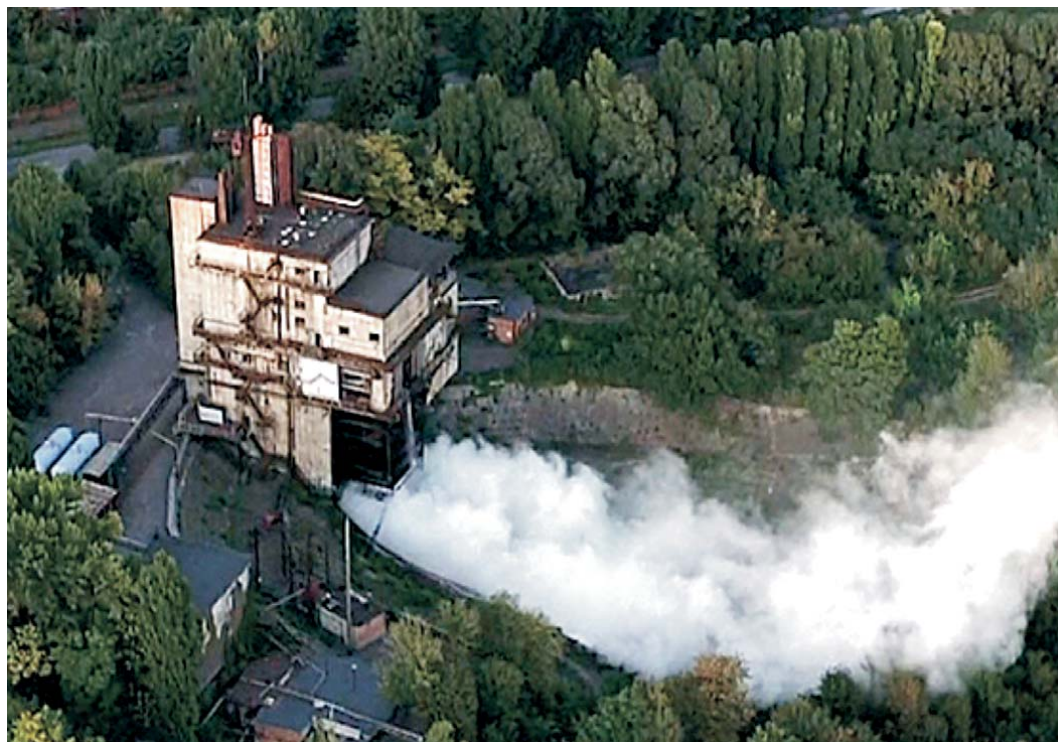
Вогневі стендові випробування 3-го ступеня РН «Циклон-4» з двигуном РД861К
