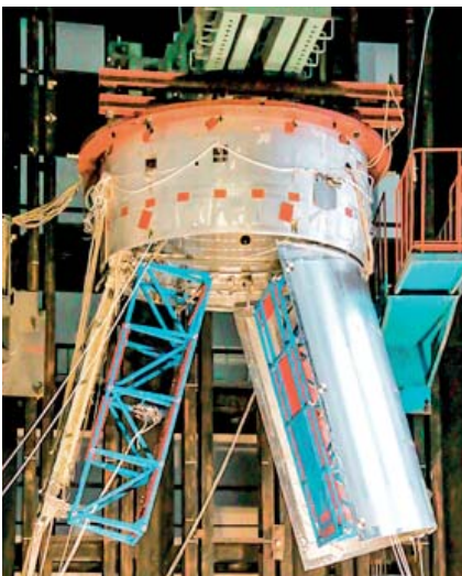
Система відокремлення КА «Іридиум» від КГЧ РН «Дніпро»
