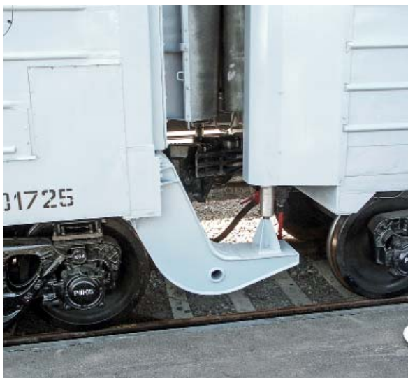
Розвантажувальний пристрій, що передає частину навантаження на сусідній вагон
