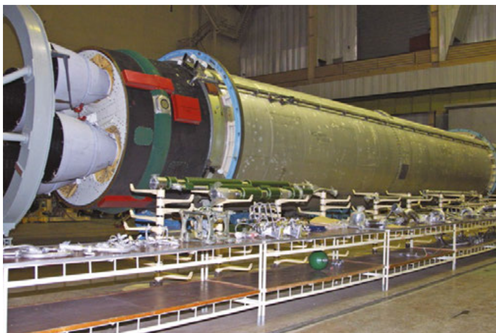
Сборка ракеты-носителя «Зенит» на Южмаше
