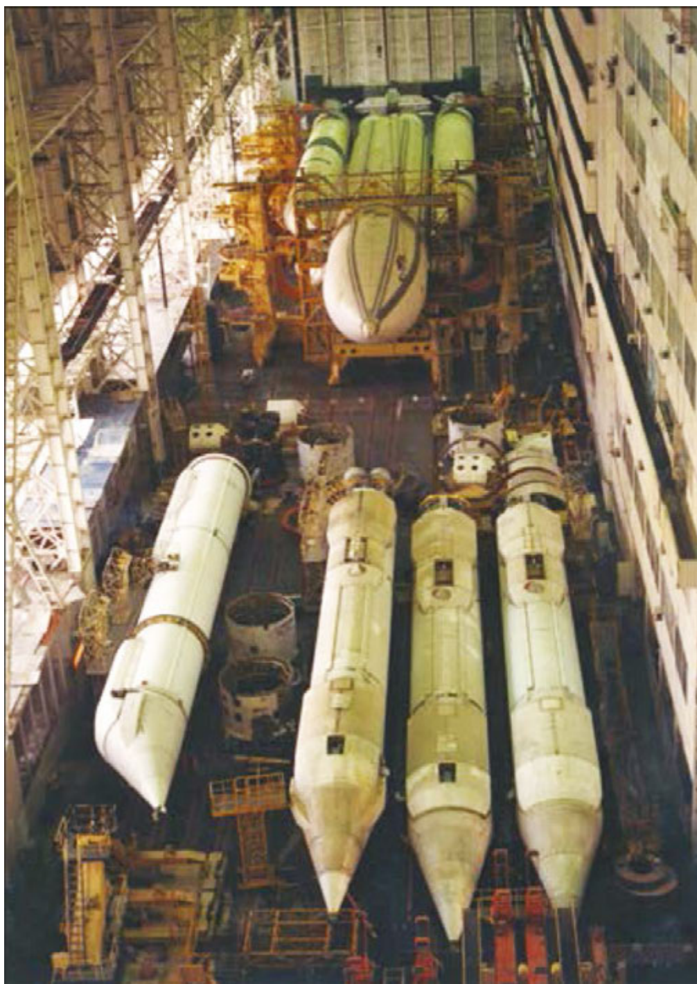
Первая ступень РН «Энергия» состояла из четырех боковых блоков А разработки КБ «Южное» и изготовления ЮМЗ
