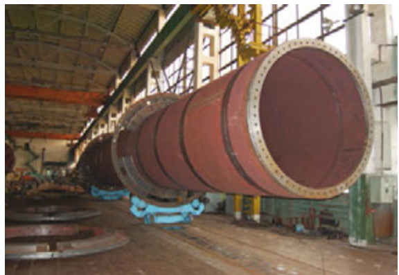
Изготовление башни для ВЭУ-600 в цехе инструментального производства
