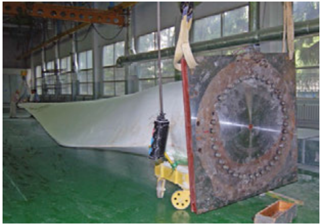
Лопасть ветротурбины Т-600-48, изготовленная на Южмаше
