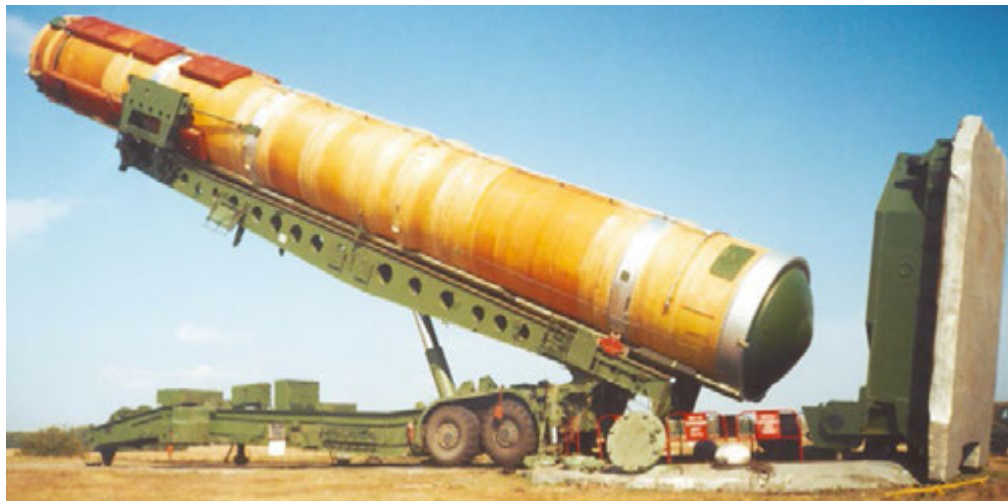
Транспортно-пусковой контейнер с МБР РС-20В устанавливается в шахтную пусковую установку
