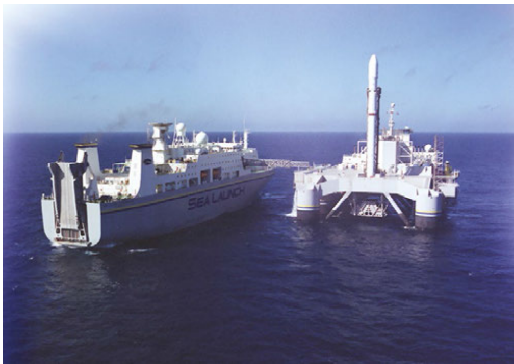
Стартовая платформа «Одиссей» с ракетой-носителем «Зенит-3SL» и сборочно-командное судно «Си Лонч»
