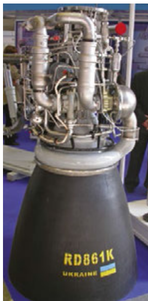
Двигатель РД-861К для третьей ступени ракеты-носителя «Циклон-4». Разработан КБ «Южное», изготавливается ЮМЗ
