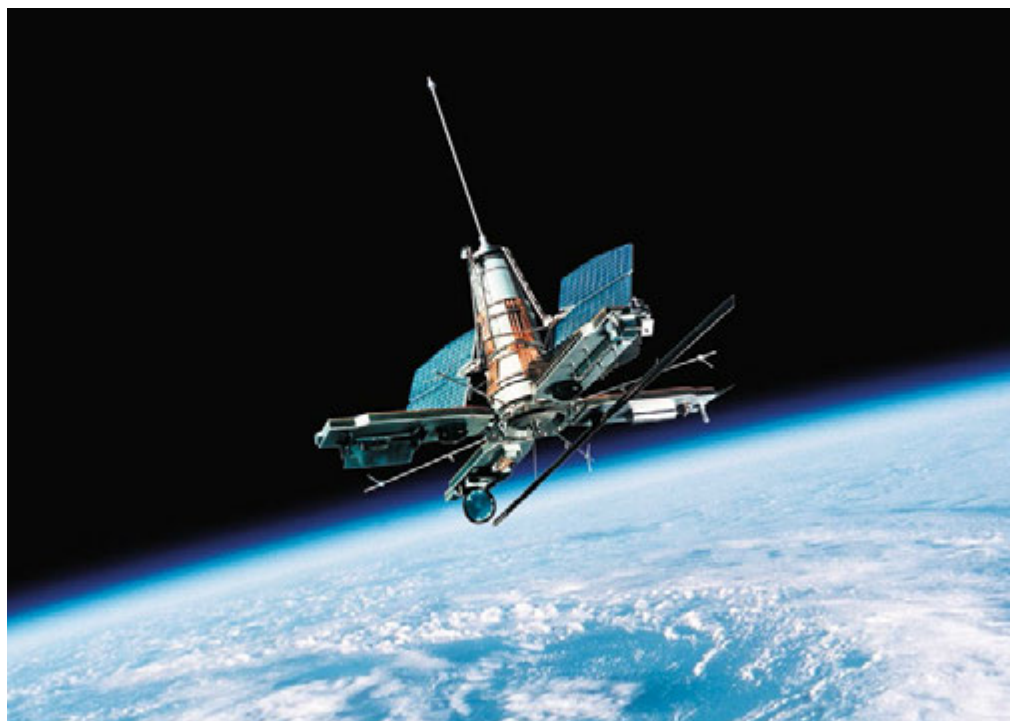
Космический аппарат дистанционного зондирования Земли «Сич-1», изготовленный на Южмаше и выведенный в космос в августе 1995 года
