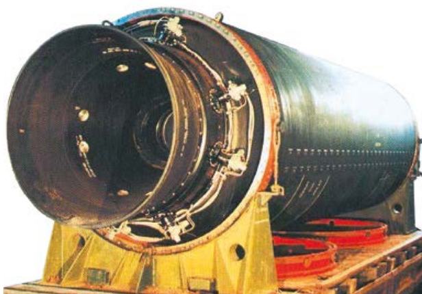
Твердотопливный двигатель ЗД65 для первой ступени морской ракеты РСМ-52 (ЗМ65)
