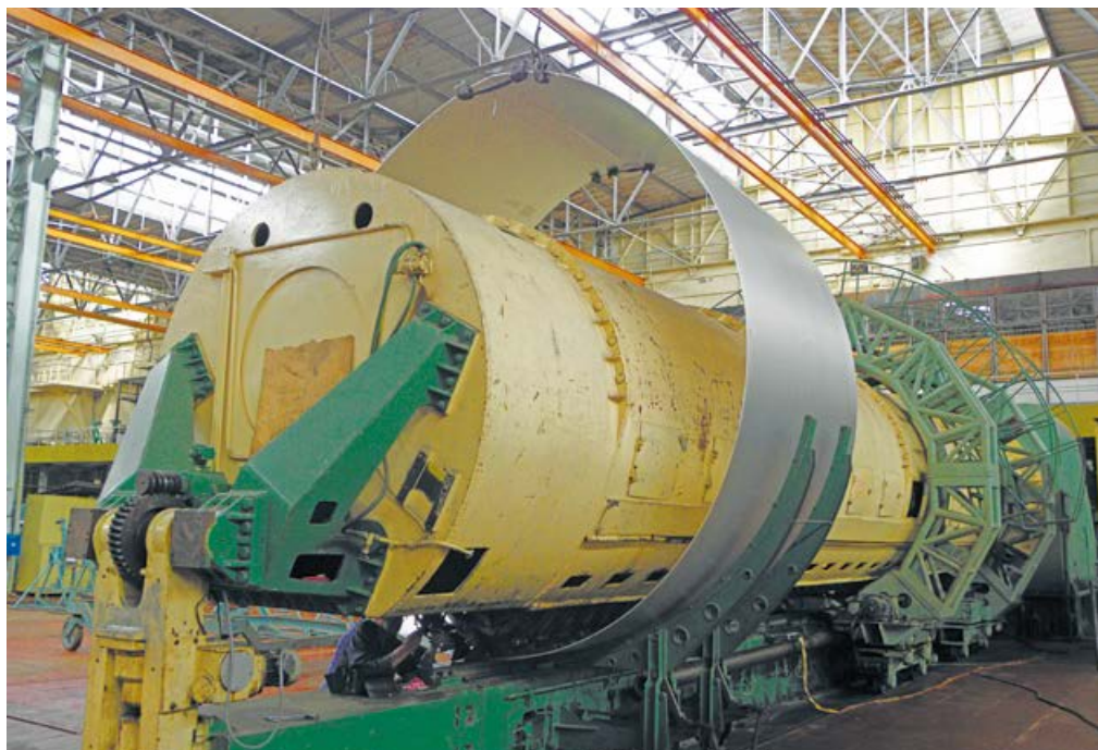
Изготовление обечайки из нагартованного листа
