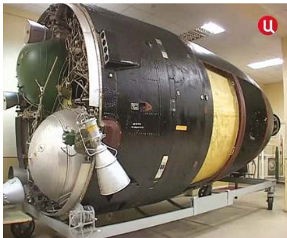
Головная часть МБР Р-36М2 «Воевода». Внутри размещались 10 ядерных боевых блоков
