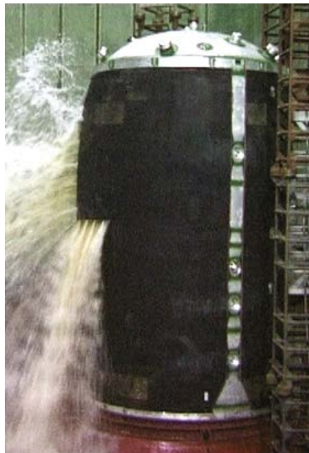
Нагружение бака ракеты Р-36М2 внутренним давлением до разрушения
