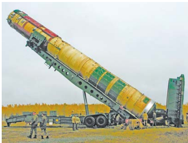
Установка в ШПУ транспортно-пускового контейнера с ракетой Р-36М УТТХ (15А18)
