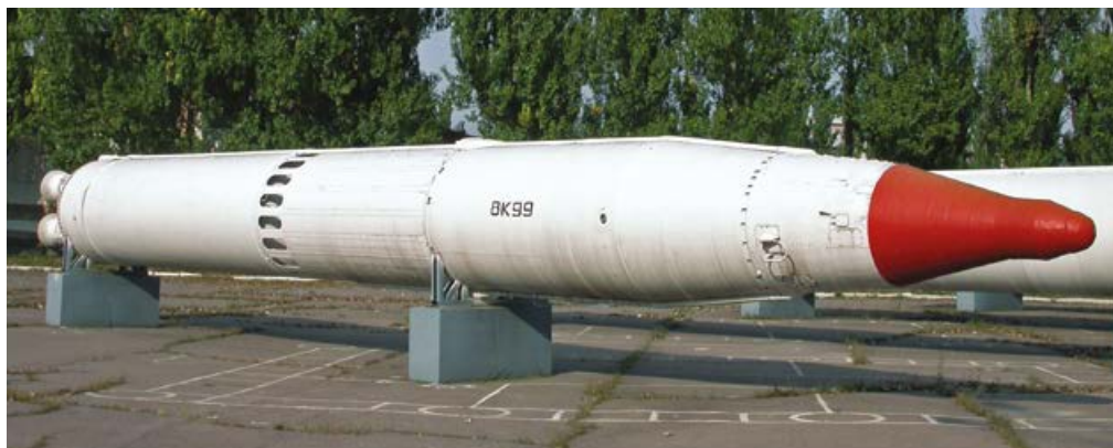
Экспериментальная ракета 8K99 с твердотопливной первой и жидкостной второй ступенями
