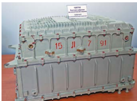
Серийная БЦВМ разработки КБ электроприборостроения (г. Харьков). Изготавливалась на Киевском радиозаводе
