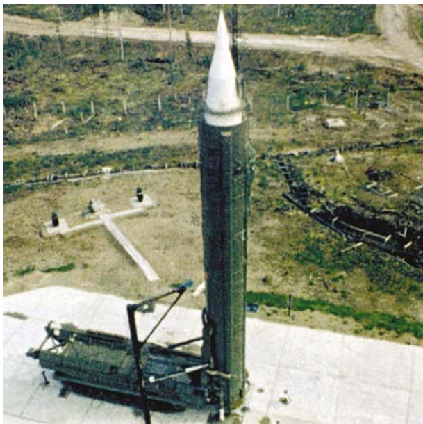
В октябре 1967 года на полигоне Плесецк начались летные испытания гибридной ракеты 8К99 с твердотопливной первой и жидкостной второй ступенями
