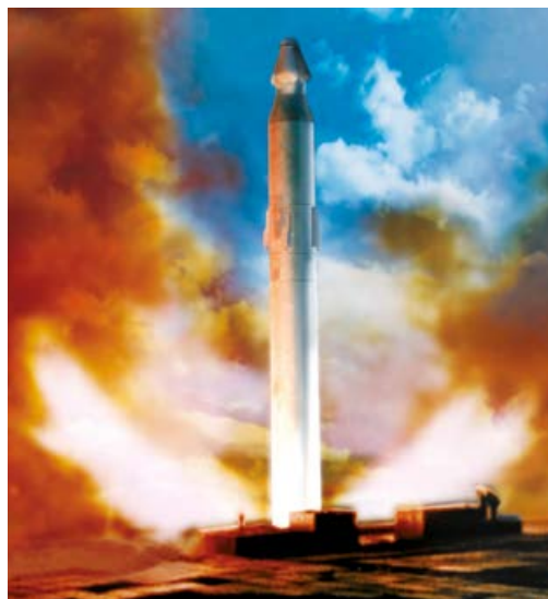
Газодинамический старт из ШПУ МБР Р-36 с разделяющейся головной частью
