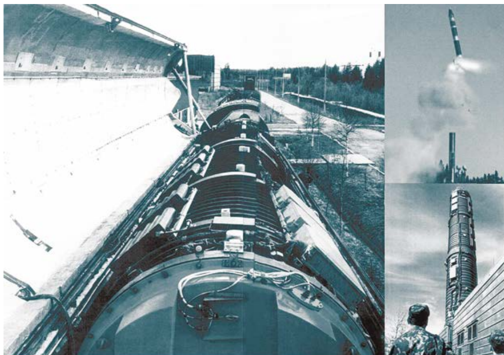
Открытие крыши вагона-пусковой установки БЖРК, вертикализация ТПК, минометный старт
