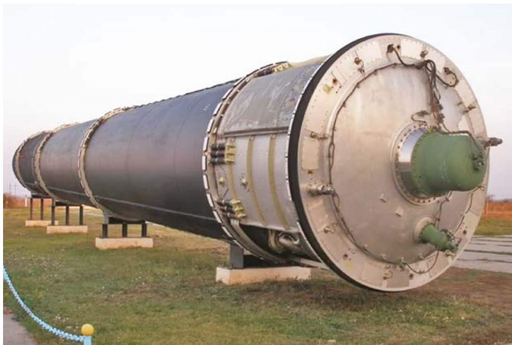
Ракета Р-36М2 «Воевода» в музее РВСН под Первомайском в Николаевской области Украины. В хвостовой части – литое днище (серебристого цвета) с пороховым аккумулятором давления (зеленого цвета)
