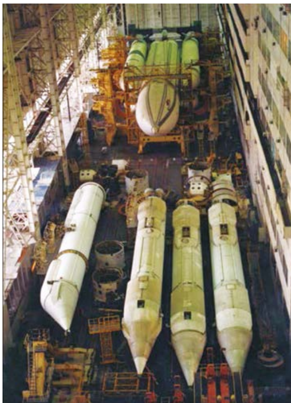
Сборка ракеты-носителя «Энергия» в МИКе космодрома Байконур. На переднем плане – четыре боковых блока первой ступени, изготовленные на Южмаше
