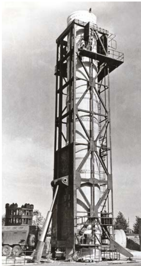
Стенд для проведения бросковых испытаний макетов ракет на полигоне Павлоградского механического завода
