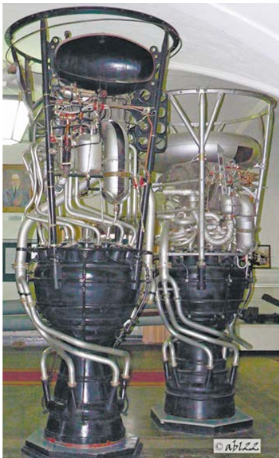
Двигатели РД-100 и РД-101 для ракет Р-1 и Р-2. В качестве топлива на РД-101 применялся 92% этиловый спирт
