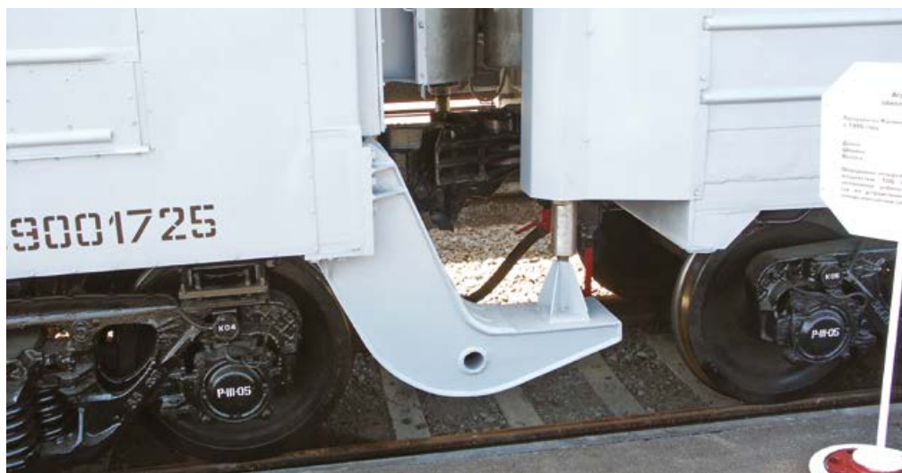
Для снижения нагрузки вагона с ракетой на колесные оси, в БЖРК были установлены специальные устройства, передающие весовую нагрузку на соседние вагоны
