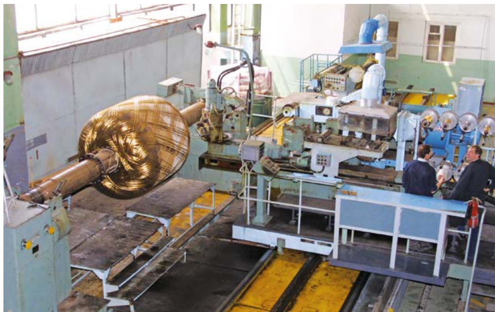
Изготовление корпуса РДТТ из полимерных композиционных материалов методом намотки
