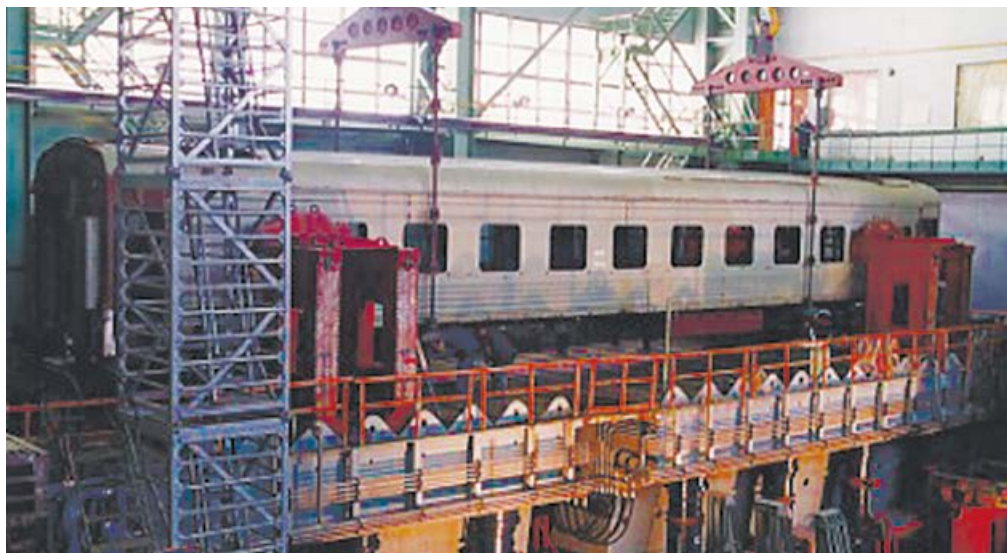
Испытания вагона БЖРК на специальном стенде, имитирующем транспортные нагрузки
