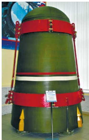
Моноблочная головная часть МБР Р-36. Мощность ядерного боезаряда – 25 Мт. Находилась на вооружении РВСН в 1967-1978 гг.
