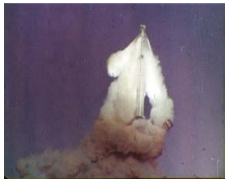
Кадры киносъемки первых бросковых испытаний макета тяжелой ракеты Р-36М из контейнера по минометной схеме. Полигон Байконур, 22 октября 1971 года
