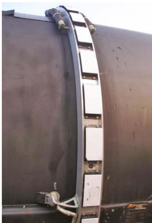
Одно из четырёх обтюраторных колец ракеты Р-36М2 «Воевода», защищающих корпус ракеты при минометном старте из пускового контейнера
