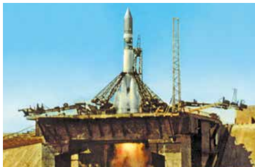
Ракета-носитель «Союз», созданная на базе знаменитой Р-7
