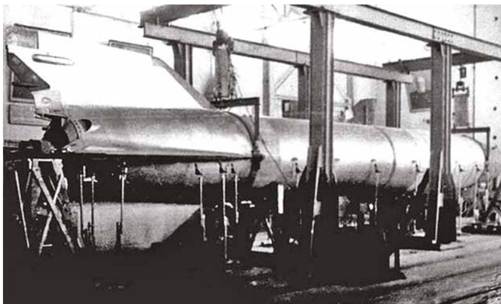
Ракета Р-2 во время вибрационных испытаний
