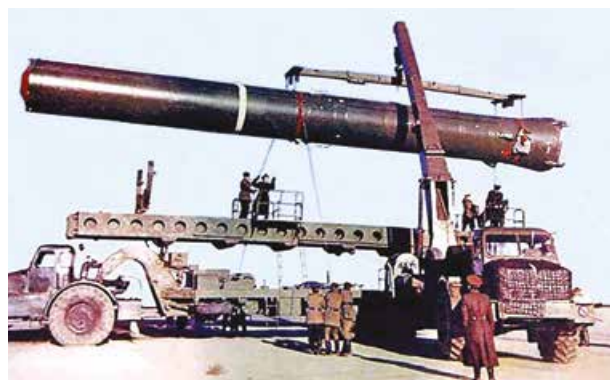
Погрузка на установщик ракеты Р-12 без головной части
