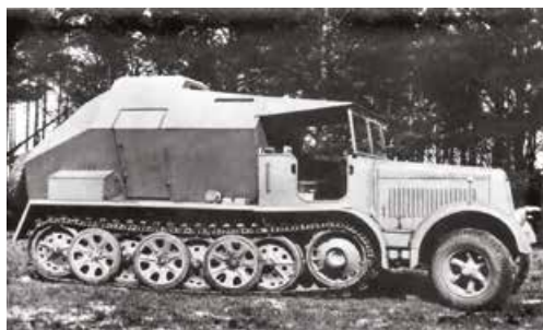
Трофейный командный пункт на базе бронемашины, из которого осуществлялось управление пусками ракет Фау-2
