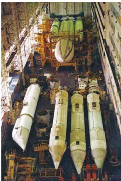
Сборка РН «Энергия» в МИКе космодрома Байконур. На переднем плане – четыре боковых блока первой ступени, изготовленные на Южмаше
