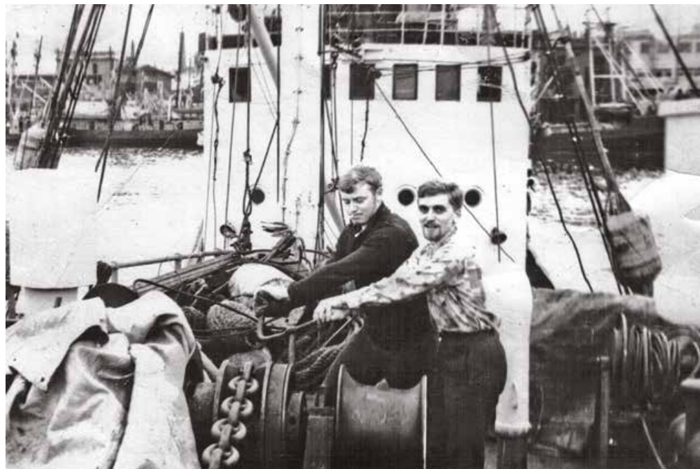
Олег Смирнов и Юрий Гринюк у брашпиля (палубного механизма для подъема якоря) на траулере «Треска» в Мурманском порту
