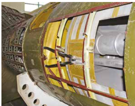
Ракета Р-2: впереди – топливный отсек, за ним – приборный, в хвосте – двигательный
