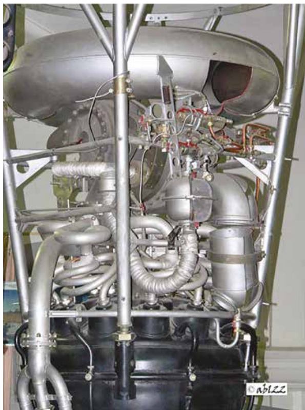
Турбонасосный агрегат с баком перекиси водорода ЖРД ракеты Р-2
