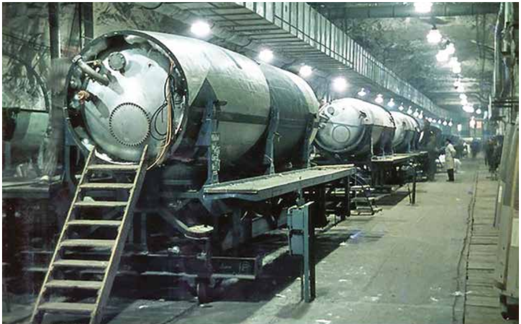
Сборочный конвейер ракет Р-1 (фотореконструкция)
