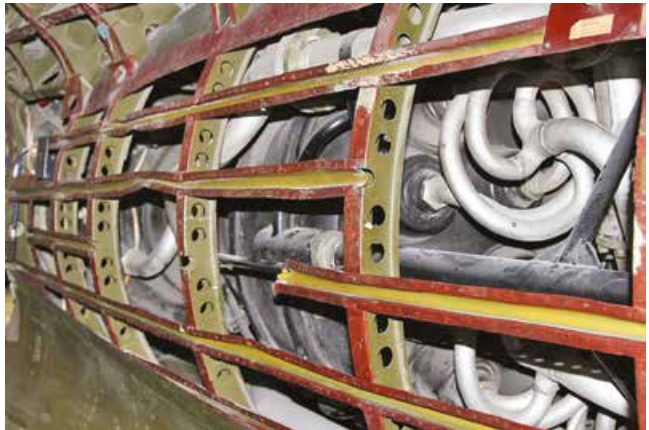
Двигатель ракеты Р-2 с вспомогательными агрегатами и трубопроводами
