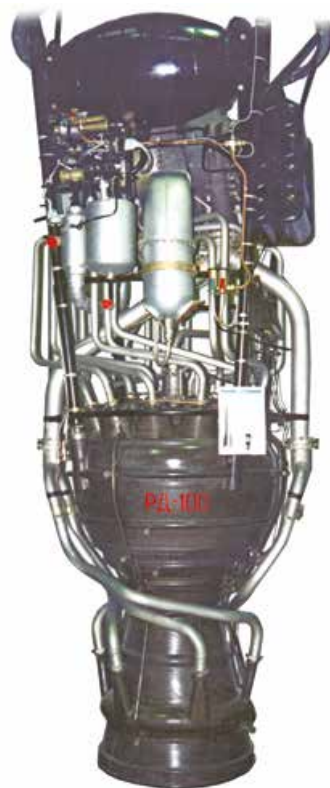
Двигатель РД-100 Главного конструктора В.П. Глушко для ракеты Р-1. Серийно производился на заводе №586 в Днепропетровске в 1950-х годах
