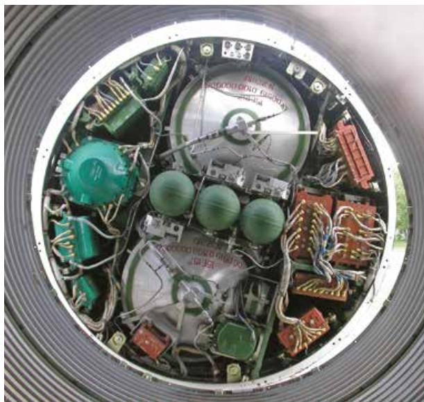
Компоновка приборов в отсеке ракеты Р-36М2 «Воевода»
