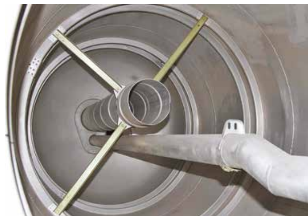
Алюминиевое днище бака окислителя ракеты Р-2
