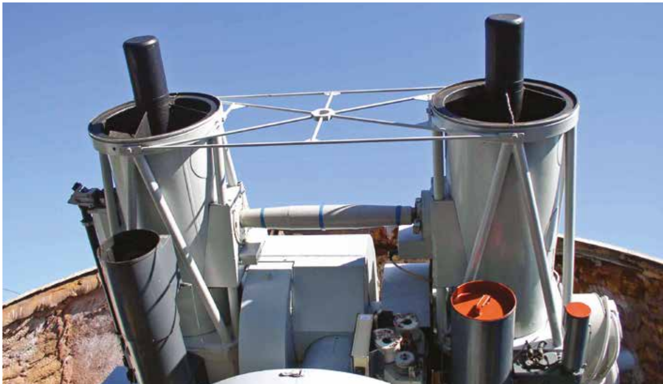
Квантова оптична система «Сажень» вимірює за допомогою лазера відстань до супутників і їх кутові координати
