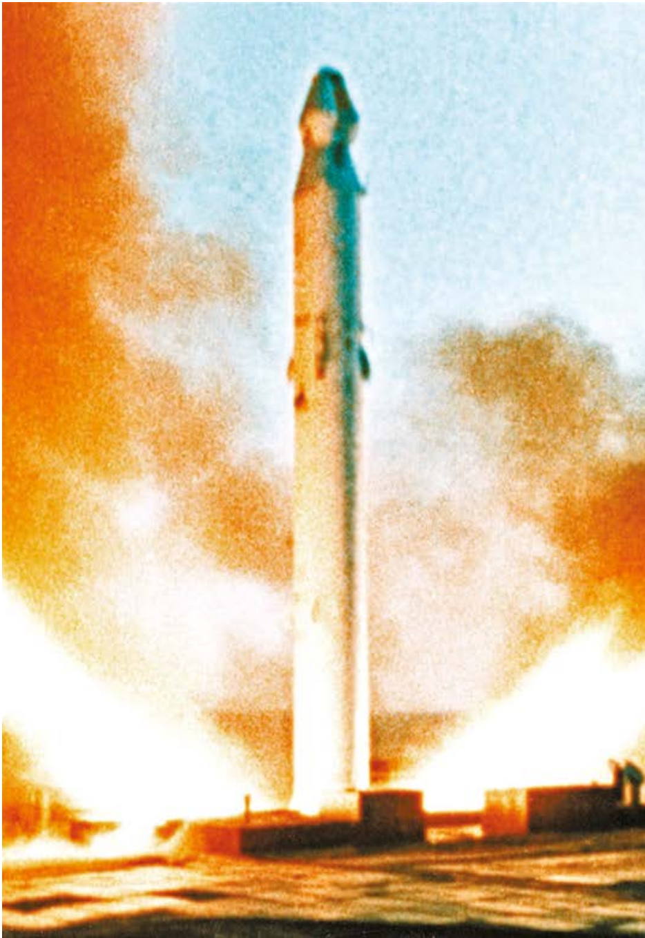
Выход из шахты ракеты Р-36П (8К67П) с разделяющейся головной частью
